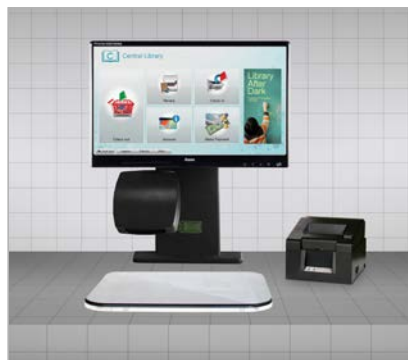
selfCheck™-componenten RFID versie 1 (gemonteerd)
